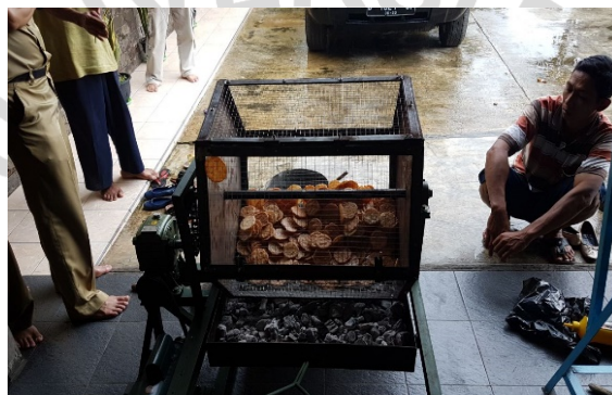
Gambar 3 : Mesin Pemanggangan Opak Ketan menggunakan Metode Roller
